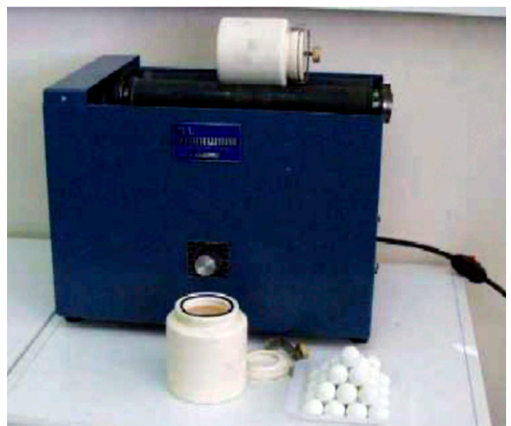
Figura 3: Molinos de bolas de laboratorio y equipo motriz.
