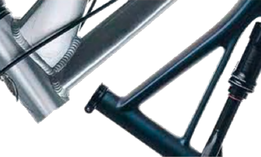
Figura 3. Cuadro de bicicleta de aluminio unido por soldadura y de materia compuestos Al-fibras de carbono.
