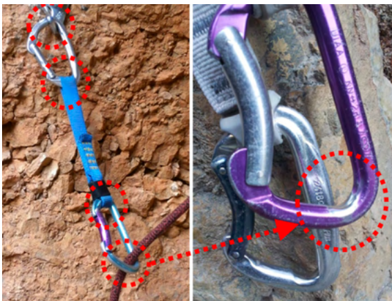
Figura 3. Zonas de desgaste y detalle de las mismas encerradas en círculo rojo.
