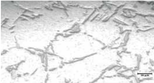
Figura 1 Microestructura de la aleación A356 sin modificación a 500x, colada en molde de arena.
