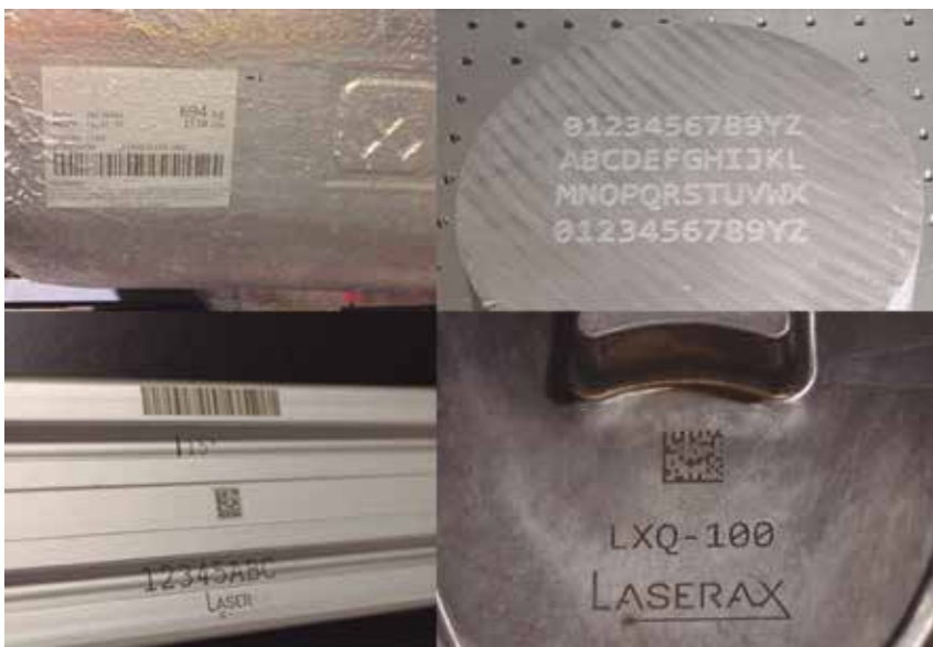
Figura 1: Marcas de láser en diferentes productos de refinерías/plantas de colada y productos semi-acabados.
