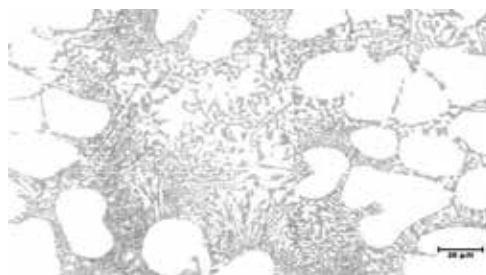
Figura 13 Microestructura del centro de la muestra en molde de metálico. Nivel 3
