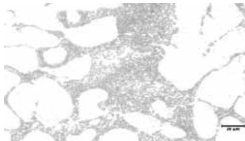
Figura 9 Microestructura de la orilla de la muestra en molde metálico. Nivel 4.
