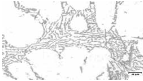
Figura 7 Microestructura del centro de la muestra en molde de arena. Nivel 3-2.
