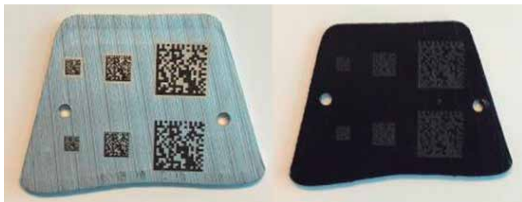
Figura 3: Marcas de láser después del recubrimiento con cromatado (izquierda) y después del e-coating (derecha)
