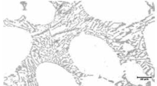
Figura 8 Microestructura de la orilla de la muestra en molde de arena. Nivel 3.
