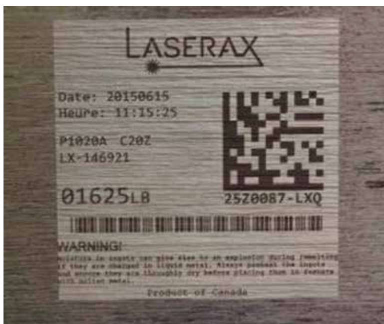
Figura 2: Marcado láser en superficies de aluminio rugoso con blanqueamiento de fondo.
