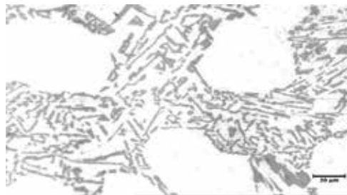
Figura 11 Microestructura del centro de la muestra en molde de arena. Nivel 2
