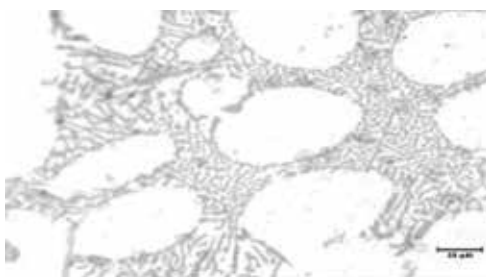
Figura 4 Microestructura de la orilla de la muestra en molde de arena. Nivel 4.
