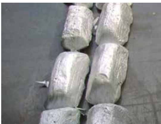
Figura 2a. Lingotes de aluminio recuperado de la escoria primaria
