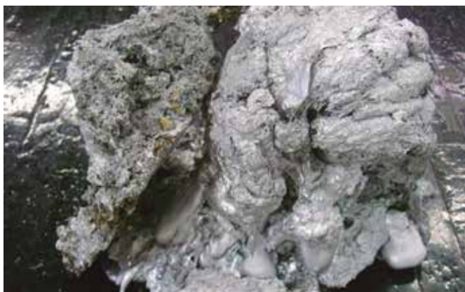
Figura 1. Imagen de la escoria industrial (escoria primaria) de la Aleación A 535 generada en la planta de fundición.
