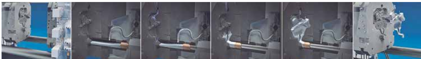
Un sistema de vacío integrado en la máquina de fundición a presión aumenta la disponibilidad de la instalación y simplifica el manejo.
