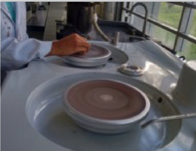
« FIG. 4 La eficiente preparación metalográfica de una muestra es el resultado del cuidado de diversos factores controlante:- flujo de trabajo, selección de equipos, procedimientos operativos desempeño de personal
