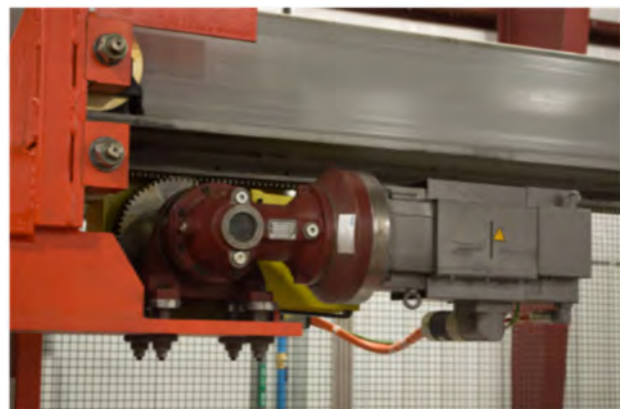
Figura 3 - Puller de Drive Directo con Motor brushless.
