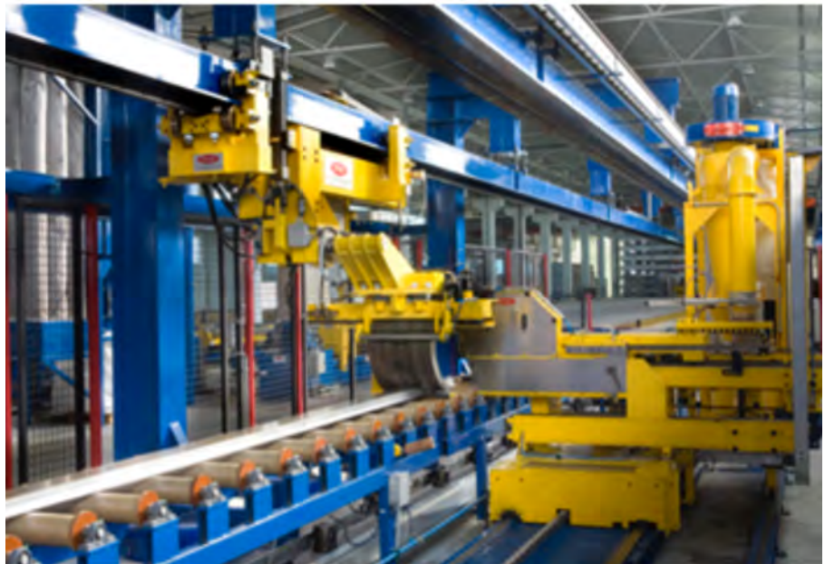
Figura 1. Doble Puller con Sierra con corte al vuelo.
