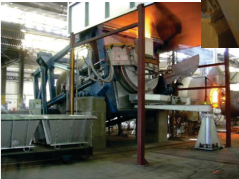
Horno Rotativo FARB con carro de escorias
