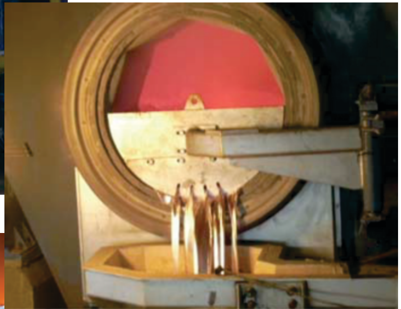
Extracción metal con reguera móvil y retenedor escorias.
