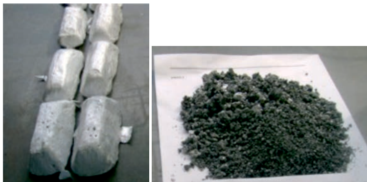
Figura 2. (a) Lingotes de aluminio recuperado de la escoria primaria y (b) Escoria secundaria obtenida después del tratamiento de recuperación de aluminio.
