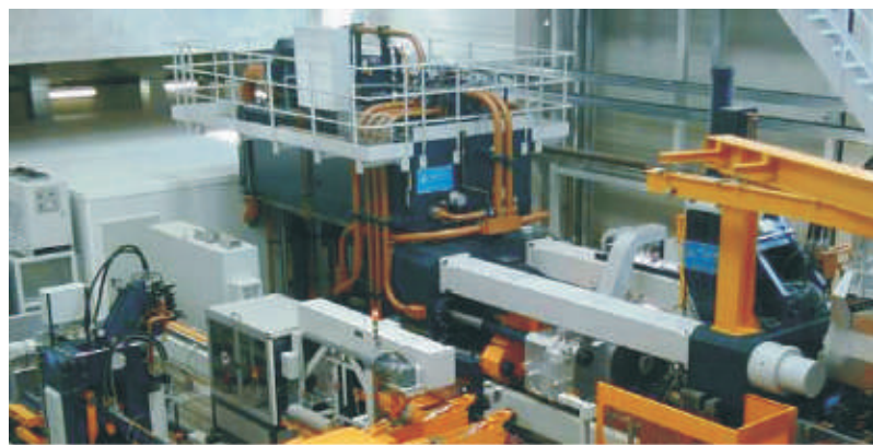
Prensa GIA de 3500 ton para la extrusión de perfiles para automoción
