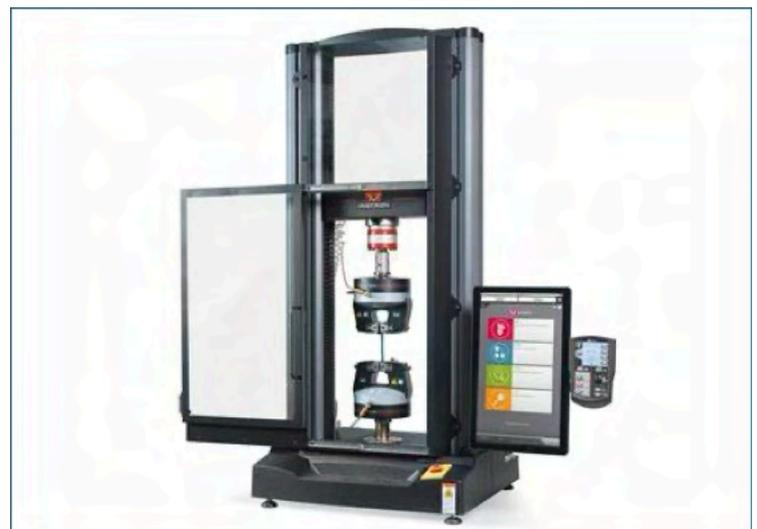
Figura 5. Máquina universal servo-hidráulica Instron 5960
