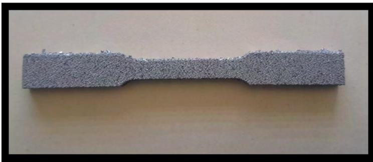
Figura 2. Muestra de tensión fabricada de acuerdo con la norma ASTM E8.
