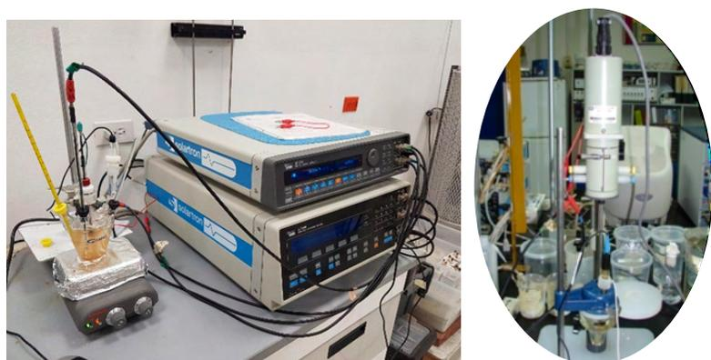
Figura 1. Equipo de corrosión electroquímica para estudio de materiales metálicos.
