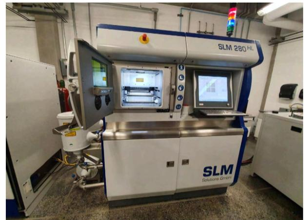
Figura 5. Equipo de manufactura aditiva utilizado en este trabajo.
